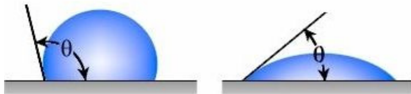
Figura 5 – Desenho esquemático do ângulo de contato entre uma gota e a superfície de uma folha
