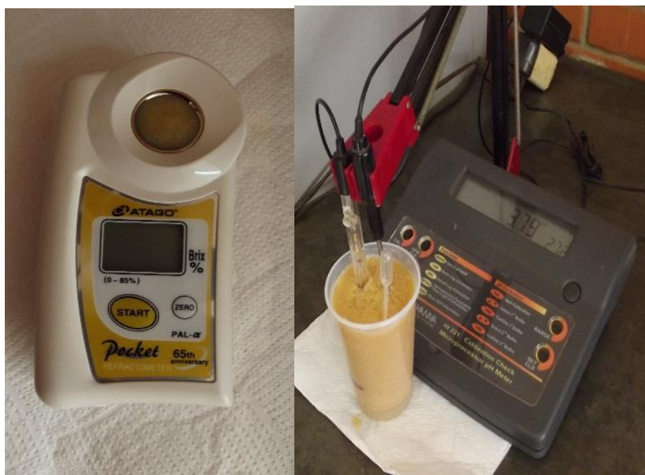
Figura 7. Medição de °brix e pH
