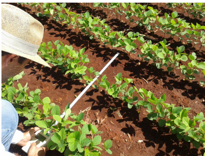
Figura . Determinação do IAF no estágio V3 da soja, com o auxílio do Ceptômetro ACCUPAR LP 80.
