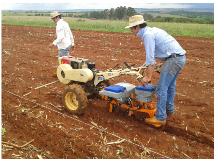
Figura . Semeadura da soja Anta 82 RR utilizando uma semeadora de linha única acoplado ao micro trator.
